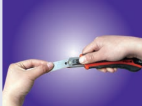
1、將推鈕向前推至美工刀柄最前端後將刀片取下
